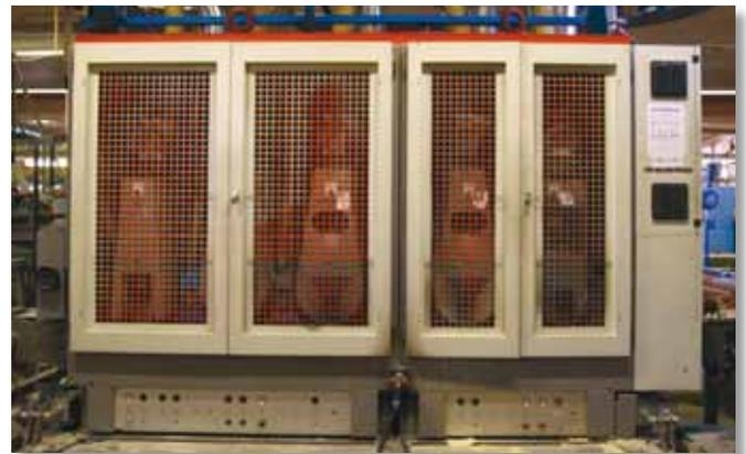
El sistema Firefly de Protección de Lijadoras está diseñado para indicar rápidamente alguna falla dentro de la máquina, antes de que aparezca el incendio, extinguiendo el riesgo a partir de nebulizado de agua. La extinción está diseñada para cubrir rápidamente el área cerrada y crear un ambiente inerte.
