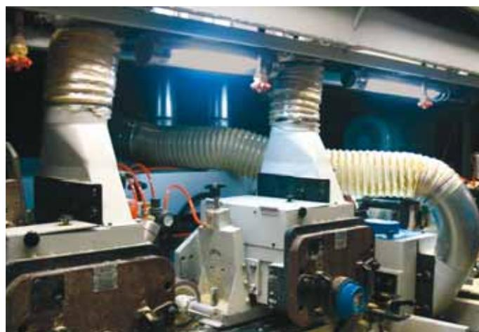
El Sistema Firefly de Protección de Cepilladora (Planer Guard) detecta chispas o fuego incipiente en una temprana etapa. Este sistema puede ser diseñado a partir de un análisis costo-eficiencia dado el compacto diseño de la moldurera.
