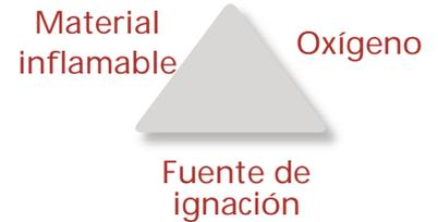
La madera es un material particularmente inflamable. El polvo de madera en un filtro puede incendiarse a partir de 470°C (878°F). En un silo, esta temperatura de ignición se reduce hasta un rango de 260°C (500°F)\*.
