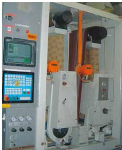
Detectar chispas dentro de una lijadora es difícil para los operarios debido al encapsulamiento de la máquina. De cualquier manera, esto no representa ningún problema para la instalación de un sistema Firefly de detección y extinción.
